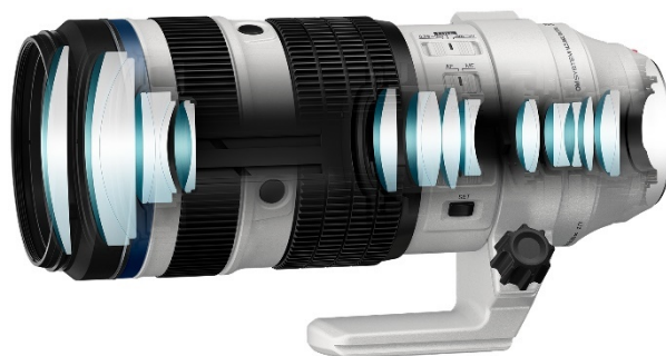
21 elementi in 13 gruppi che forniscono un'eccellente risoluzione ai bordi dell'immagine su tutta la gamma di zoom
